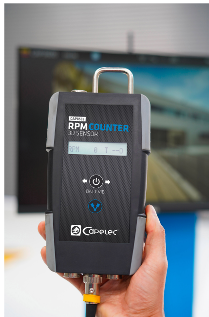
Capteur 3D CAPTHOS Boîtier renforcé Ecran LCD Connectivité sans fil avec les analyseurs et les opacimètres
