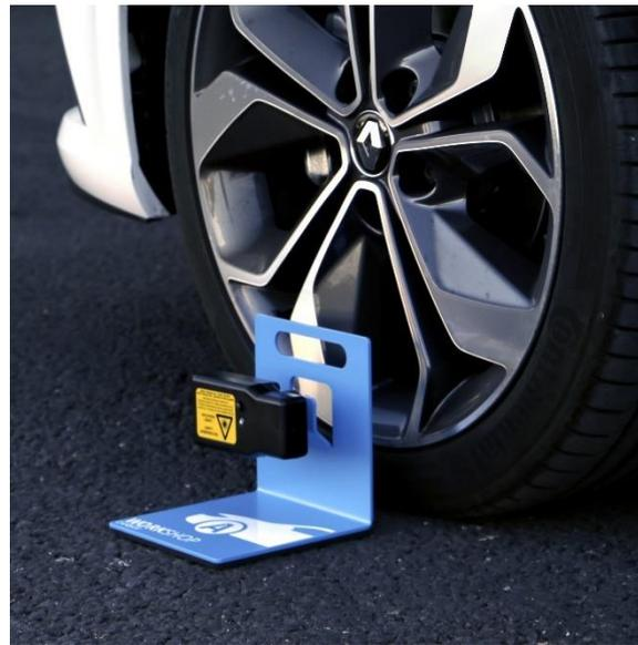
Pour activer le laser du module A, appuyer 2 secondes sur l'interrupteur. Le pointer sur la ligne cible du module B.
