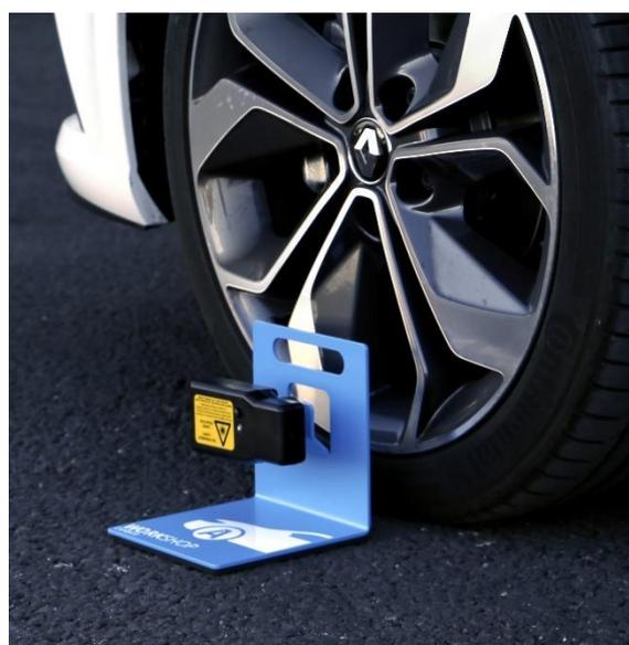
Para activar el láser del módulo A, pulsar el interruptor durante 2 segundos. Apuntarlo a la línea objetivo del módulo B.
