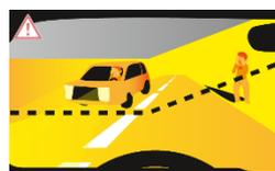
Reglaje demasiado alto con riesgo de deslumbramiento
