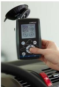
*Opción: módulo inalámbrico dual decelerómetro y podómetro*
