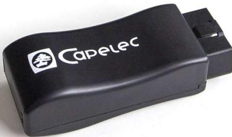
**Compacto y robusto, el módulo se integra en el sistema de medición de emisiones. Autónomo, detecta automáticamente el protocolo**
