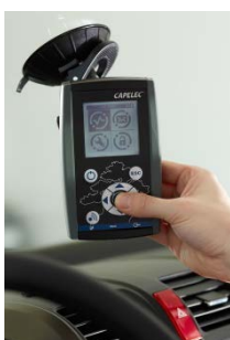
Opción : modulo dual inalámbrico decelero-pedómetro
