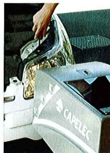
La quasi-totalité des règle-phares électroniques dispose d'un programme d'accompagnement au réglage.
