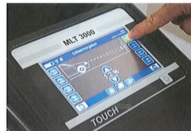
Les règle-phares électroniques de dernière génération à caméra CCD peuvent disposer d'un écran tactile qui suggère à l'opérateur l'ensemble des opérations à mener.
